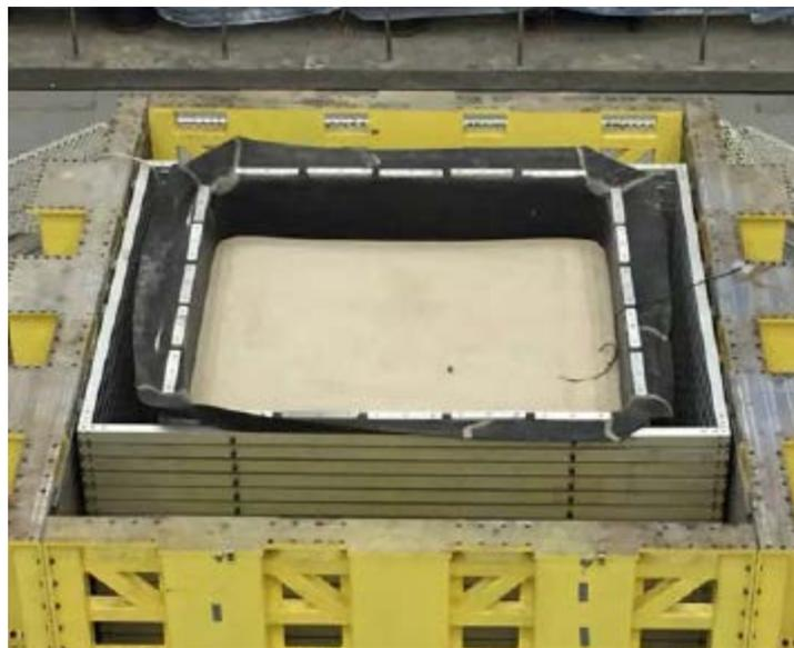
圖 7 滿載乾砂試體振動台性能測試
