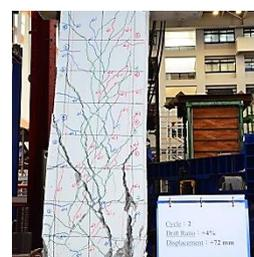
圖5 動力加載後試體裂縫發展與最終破壞情形(續)
