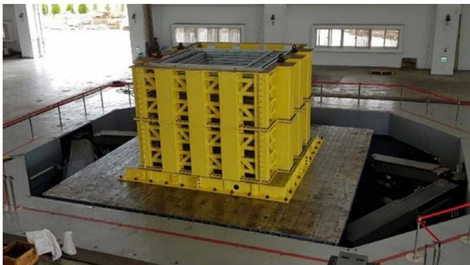
圖 5 剪力盒空箱測試安裝照片
